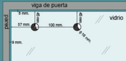
medidas de perforado en vidrios para TMZ-TP28
