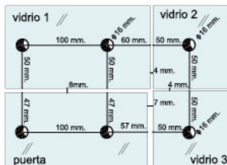
medidas de perforado en vidrios
